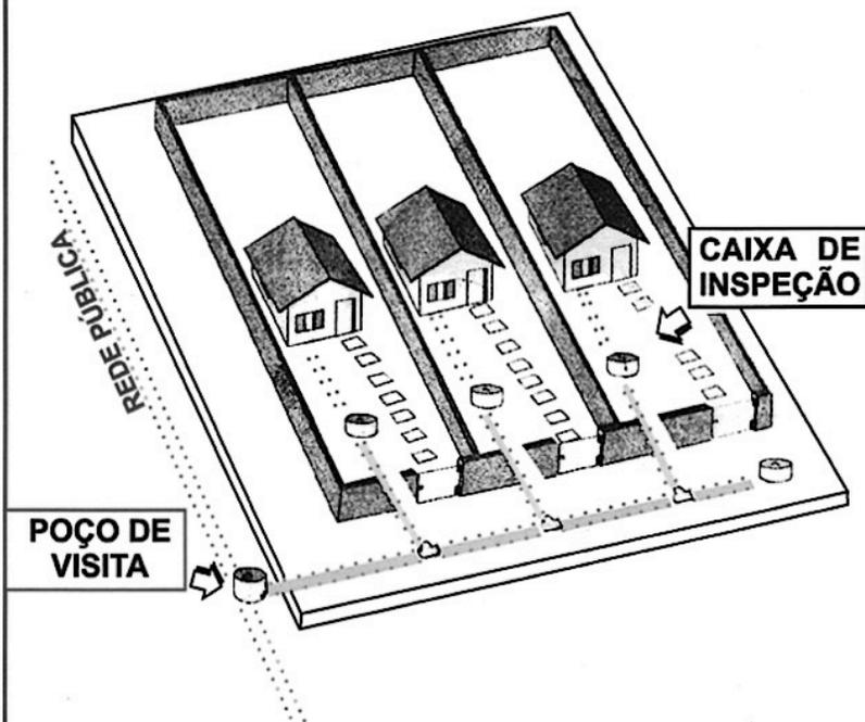
A Caesb constrói a rede pública, os ramais e uma caixa de inspeção para cada lote. Os moradores são responsáveis pela ligação de suas instalações internas (banheiro, pia, tanque, etc) até a caixa de inspeção construída.
